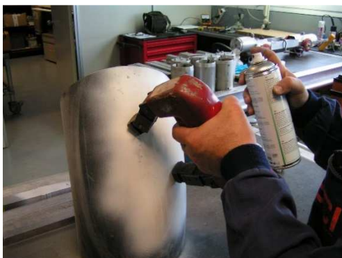
Ejecucion ensayo particulas magneticas
