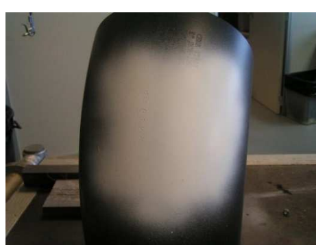
Aplicación de pintura de contraste
