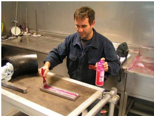
Ejecución ensayo líquidos penetrantes.
