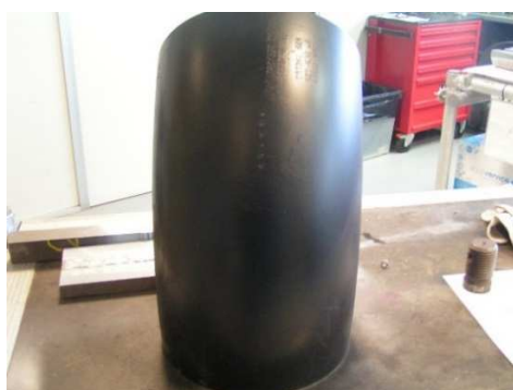
Codo antes del ensayo sin indicaciones a simple vista
