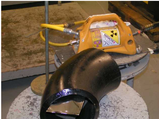
Ejecución ensayo radiográfico.
